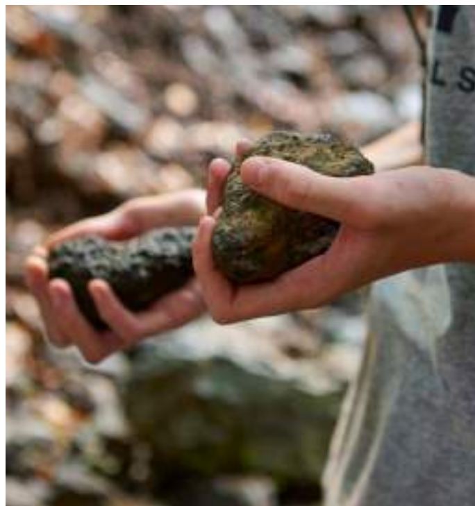
Pere con dos piedras volcánicas del mismo tamaño pero distintas; una es toba y la otra es basalto. Las diferencias están en el peso, la textura y la densidad.
